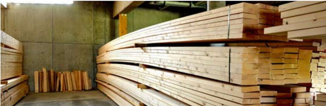
Ausgangsprodukt in unserer Produktionslinie sind Holzbretter geschnitten im Rift- oder Halbriftnschnitt. Diese werden von uns beginnend von der Keilzinkung, über die Verdübelung zum DD-Element, weiter zur CNC-Abbundanlage sowie Handabbund, bis hin zur Montage durch unser eingespieltes Team verarbeitet.
