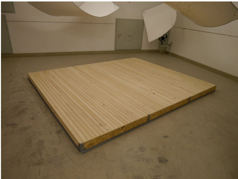
Abbildung B.2. Prüfaufbau im Hallraum (prüffertig).
